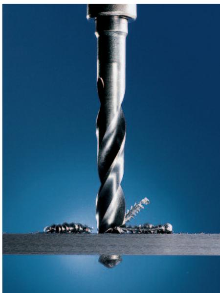
Bohren eines XAR® 400-Blech
